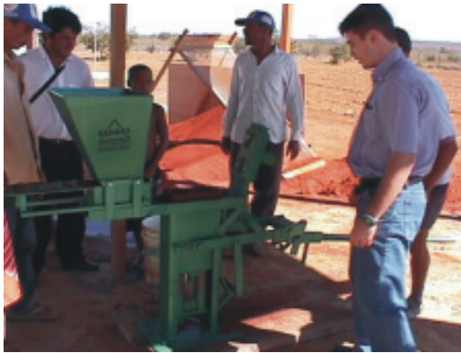
Ilustração 2 – Máquina para fabricação de tijolos de solo-cimento em João Dourado – BA Crédito: Moscatelli/ 2003
